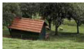
Die Dachform und -eindeckung ist landschaftstypisch zu wählen. Ein Satteldach mit 20 - 30° Neigung passt sich erheblich besser in die Landschaft ein als ein Pultdach. Zudem kann dadurch zusätzlicher Stauraum geschaffen werden.
